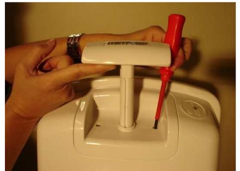
Poussez sur le bloc commande. Vissez les deux vis du bloc.
